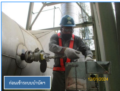
ภาพที่ 2.2 การตรวจวัดประสิทธิภาพของระบบบำบัดมลพิษอากาศ
