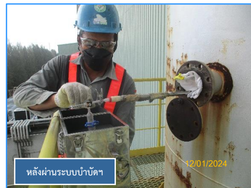
ภาพที่ 2.2 การตรวจวัดประสิทธิภาพของระบบบำบัดมลพิษอากาศ
